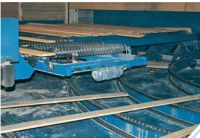
Schnittware gelangt direkt von der Besäumanlage mit Zwischenpuffer zur Sortierung
