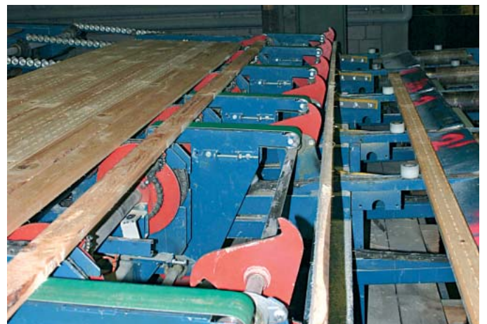
Vor der Einteilung in die Boxen wird das Schnittholz mittels Wender noch beidseitig begutachtet
