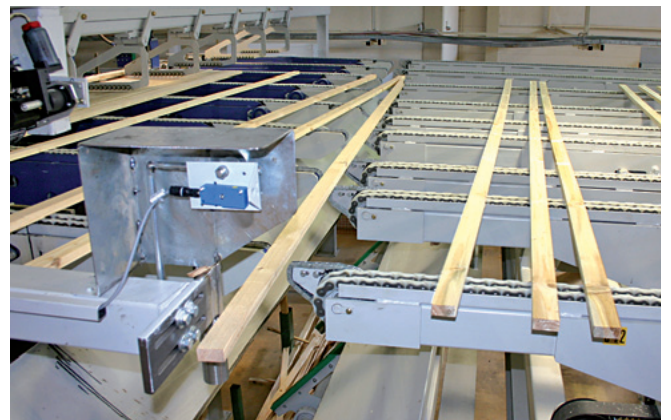
Ausschussbrett bleibt bei einem Anschlag hängen und fällt diagonal durch eine Lücke nach unten
