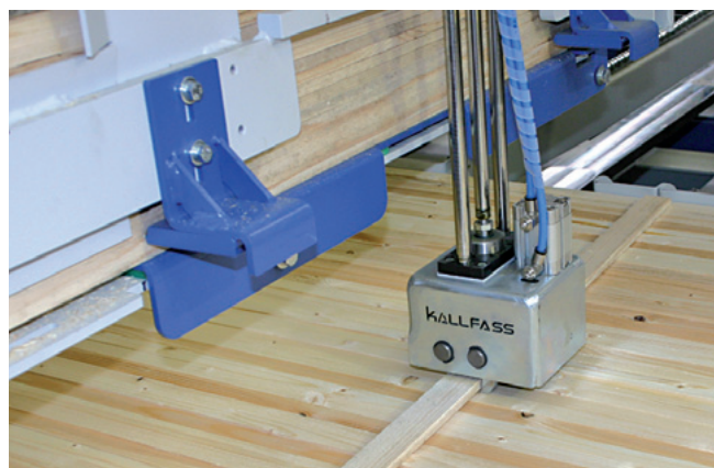
Automatische Lattenlegung mit bis zu vier Magazinen ist bei der Stapelbildung möglich
