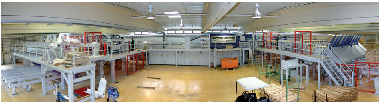
GELO-Hobelwerk: rechts die Aufgabe, in der Mitte die Hobelmaschine, links die Abstapelung
